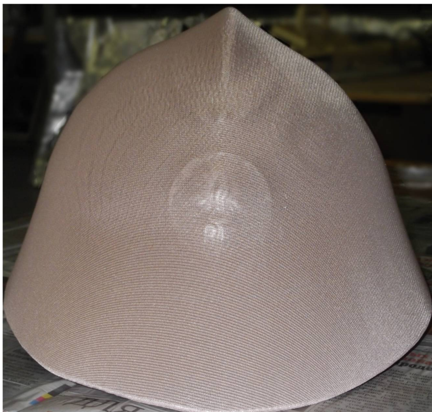
Рис. 4.8. Обтягивание каски трикотажем
