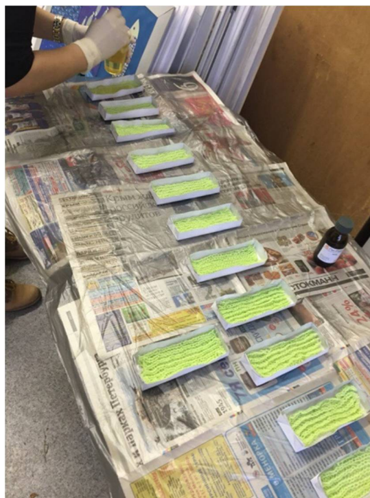
Рис. 2.18. Подготовка образцов методом ручной выкладки
