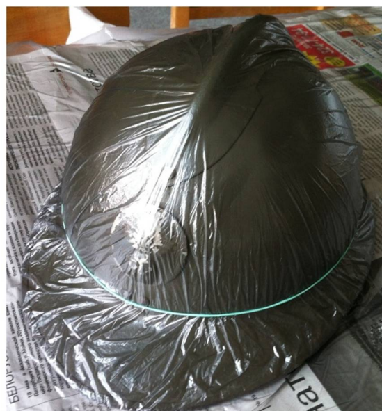
Рис. 4.4. Обтягивание оригинала защитной плёнкой
