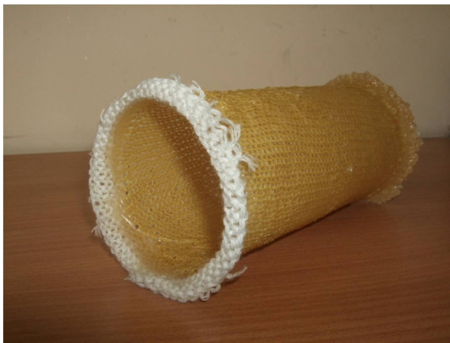
Рис. 4.22. Бесшовная труба с кулирным трикотажным наполнителем, связанным на плосковязальном автомате
