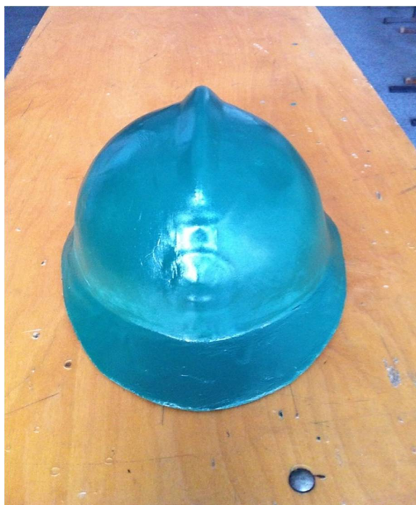
Рис. 4.16. Реплика каски, полученная двухпроцессным способом (внешний вид)
