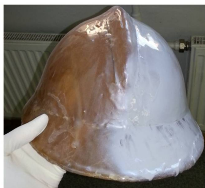
Рис. 4.12. Грунтовка заготовки: а – используемый баллончик; б – процесс грунтования; в – полученный после высыхания всех слоёв результат
