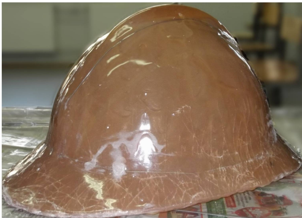
Рис. 4.11. Заготовка, снятая с формы
