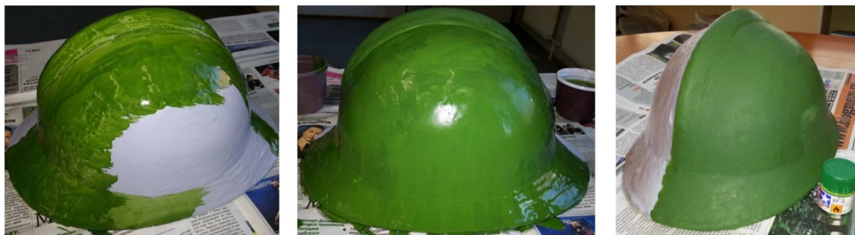
Рис. 4.13. Подбор цвета краски: а – начало окрашивания; б – завершение процесса; в – результат после высыхания краски
