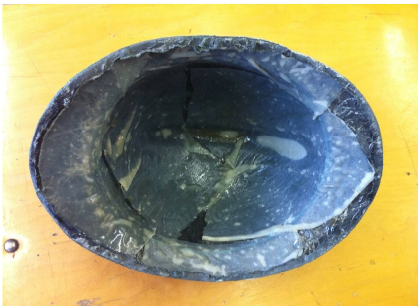
Рис. 4.17. Реплика каски, полученная двухпроцессным способом (вид изнутри)
