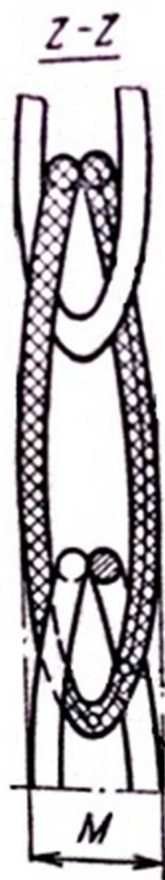
Рис. 4.6. Геометрическая модель трикотажа ластик 1+1 (по А. С. Далидовичу)
