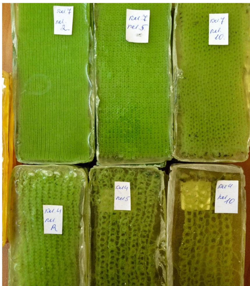
Рис. 2.19. Залитые образцы трикотажа различных плотностей вязания
