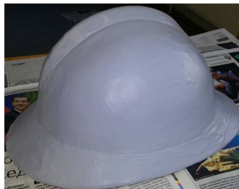
Рис. 4.12. Грунтовка заготовки: а – используемый баллончик; б – процесс грунтования; в – полученный после высыхания всех слоёв результат
