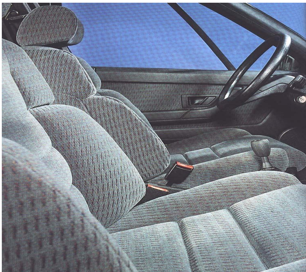
Рис. 14.16. Отделка автомобиля тканью с флокированными нитями в качестве утка
