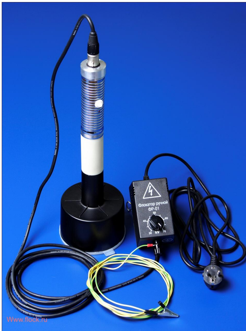
Рис. 13.3. Ручной электрофлокатор с малогабаритным источником питания
