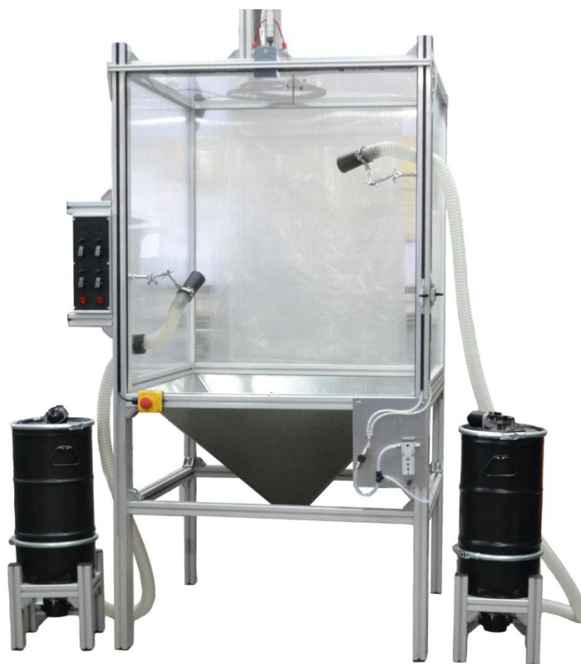
Рис. 13.11. Камера с использованием электропневмофлокатора для нанесения ворса на объемные изделия
