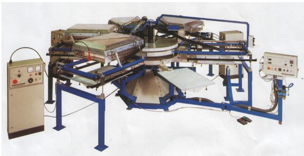
Рис. 14.4. Установка для нанесения многоцветных ворсовых рисунков на текстильные изделия путем печати ворсом
