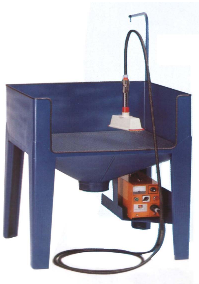
Рис. 13.5. Рабочее место для отделки различных изделий с применением ручного флокатора
