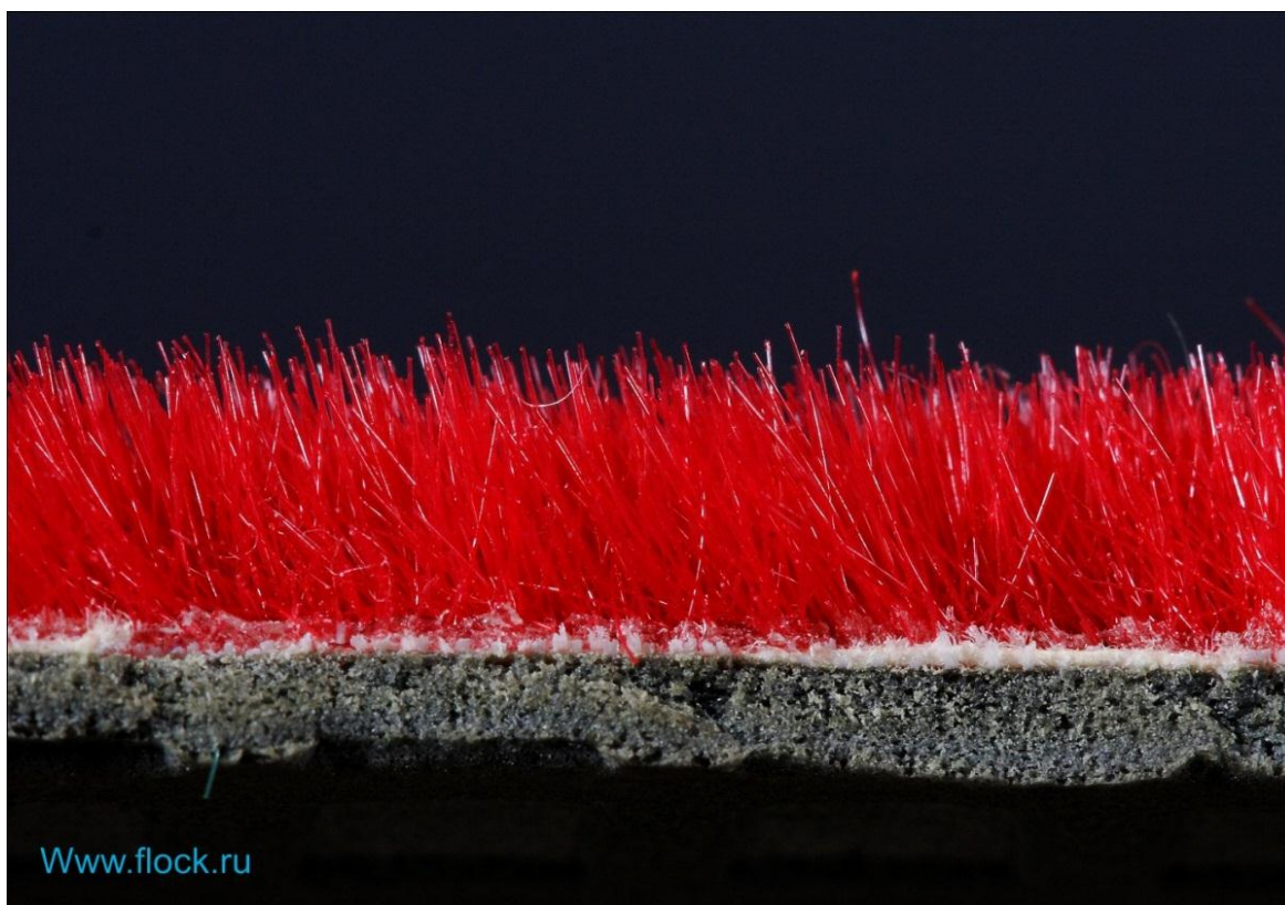
Рис. 6.1. Увеличенное изображение среза флокированного образца
