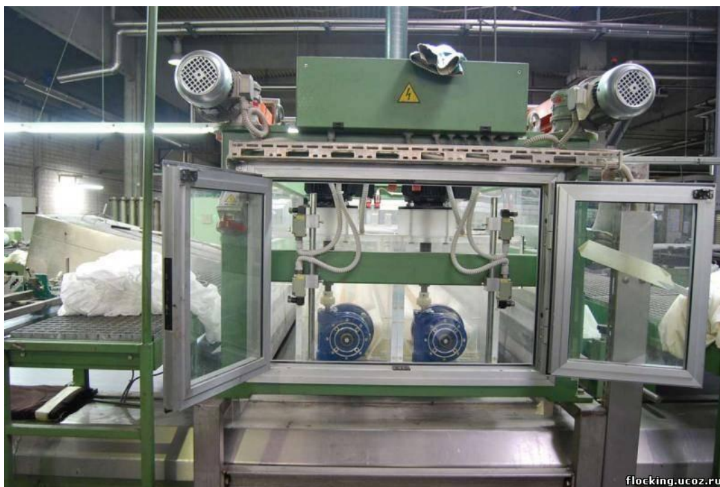
Рис. 13.8. Флокатор промышленной линии для нанесения флокированных покрытий на рулонные материалы
